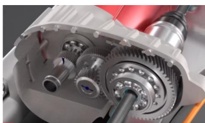
Рис. 3. Вращение вала двигателя приводит к вращению шестеренки, которая передает вращающий момент на колеса электромобиля [1]
