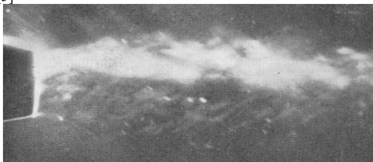
Рис. 12. Спутный газовый поток при m = 0,4 и среднерасходной скорости газа на выходе из сопла 2,5 м/с.
