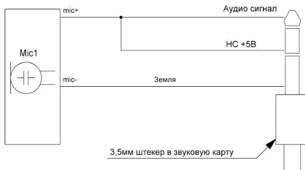
Рис.10. Подключение электретного микрофона к звуковой карте ПК
