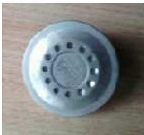
Рис.2. Внешний вид капсюля угольного микрофона.
