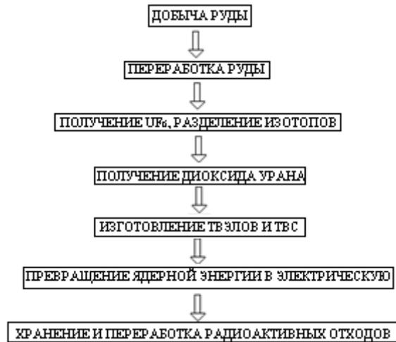
Рис.1. Технологические процессы на предприятиях, входящих в состав топливно-энергетического комплекса.
