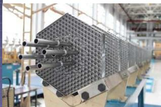
Рис.3. Каркас ТВС до установки твэлов[7].
