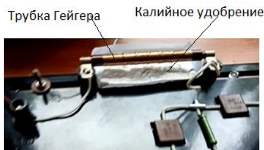
Рис. 4. Демонстрация излучения бета-лучей прибором ПДРИ
