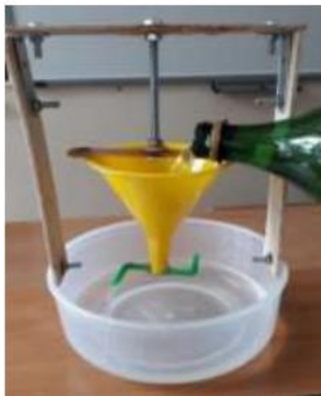
Рис. 4. Пример модели сегнерового колеса [4]
