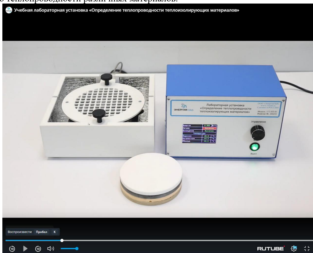
Рис. 4. Учебная лабораторная установка «Определение теплопроводности теплоизолирующих материалов»
